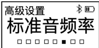
音频率。支持435~445Hz调节，调节幅度为1Hz。
